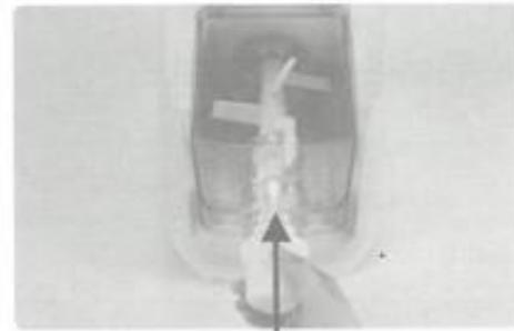
Inserte el disco en el cabezal de extrusión.
