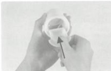
Apriete el cabezal de extrusión a la placa de fijación.
